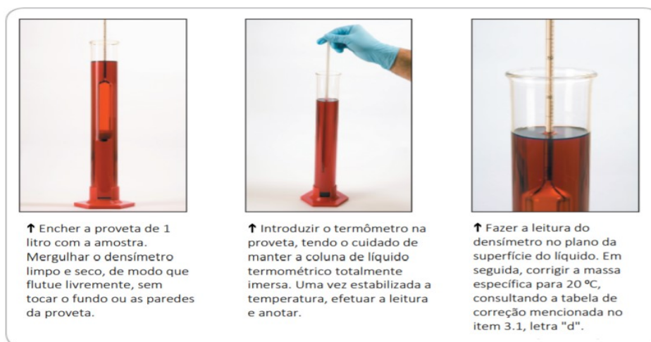
Figura 3: A análise do combustível: massa específica a 20°C.
