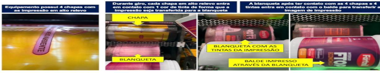
A cada giro da blanqueta as tintas são transferidas e impressas no balde. Devido ao constante contato em função da quantidade de baldes produzidos, o alto relevo da chapa fere a blanqueta marcando a mesma, com isto deve ser trocada a cada mudança de produto e avaliada a troca a cada 10.000 baldes produzidos do mesmo produto.
