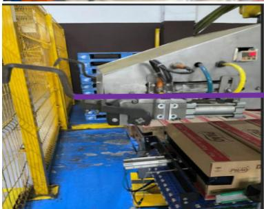
**Dedo Pega Pallet** - Garra utilizada no robô para pegar o pallet e posicionar na esteira;
