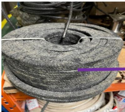
**Gaxeta Sintética** - Elemento de vedação utilizado nos derivadores de calor dos torradores;
